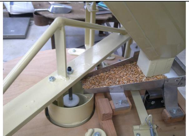
Figure : système de distribution
